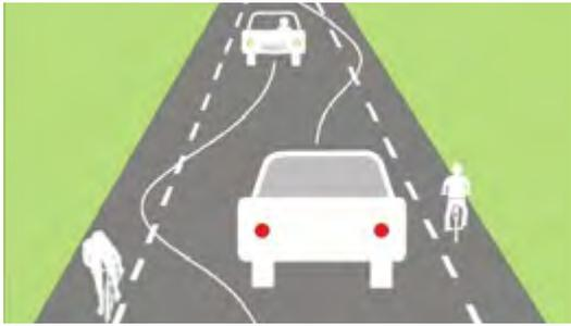
→ Le Département, en charge de l'aménagement, de l'entretien et du développement du réseau routier départemental, va expérimenter une chaussée à voie centrale banalisée entre Donges et Bouée, sur la RD 90.
